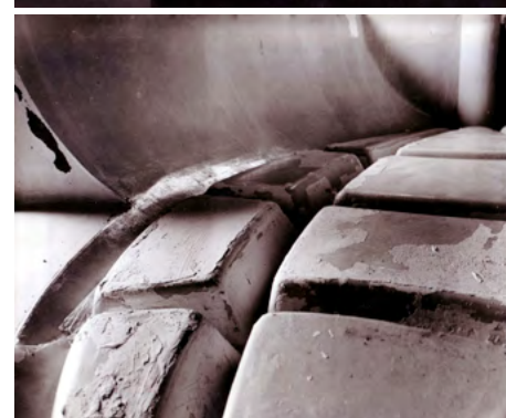
Pascal Häusermann, Habitation Noverly , 1963-1966 Vues de la réalisation des moules, du moulage et démoulage des éléments en plastique, 1963
