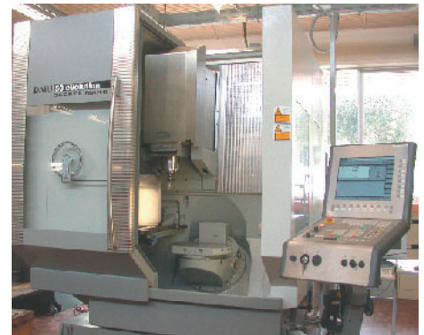
Centre d'usinage à broche verticale et deux plateaux tournants de Decke, photo prise par Glenn McKechnie 08/2005, Wikimedia Commons.
